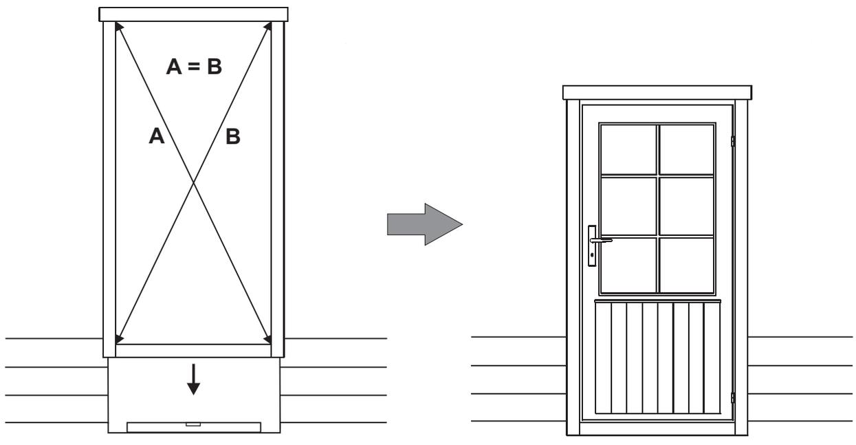
**8a. Parioven karmien asentaminen - Assembling the double door frames - Montering av dubbeldörrens karm
