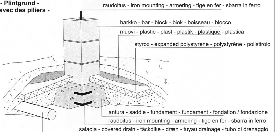
**3a. Pilariperustus (kevyt) - Pillar foundation (light) - Plintgrund (lätt) - Plintfundament (let) - Les fondations avec des piliers - Le fondazioni con i pilastri**
