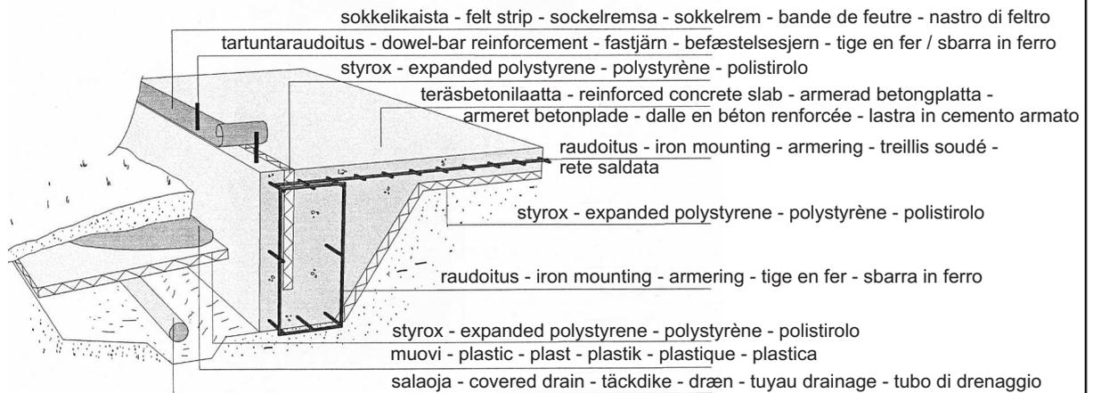
**3. Pilariperustus - Pillar foundation - Plintgrund - Plintfundament - Les fondations avec des piliers - Le fondazioni con i pilastri**
