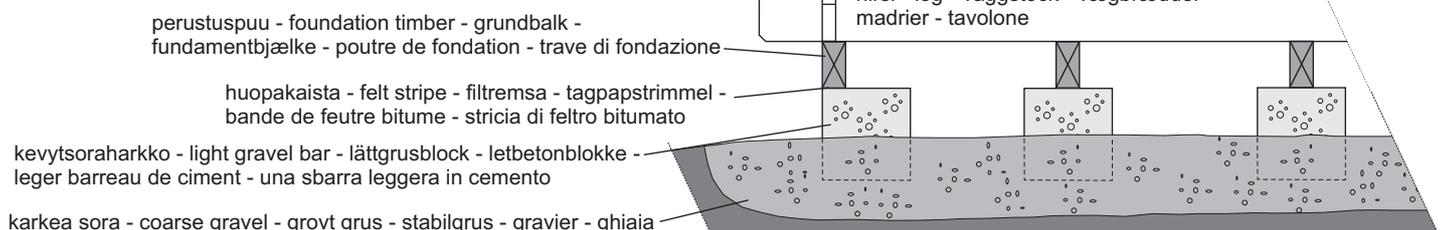
**4. Hirsien asennussuunta, perustuspuiden asettelu ja lattian kiinnitys - The assembling direction of logs, foundation beams and assembling of the floor - Monteringsdirektion av väggtrimmen, grundbalkarna och montering av golvet - Vægbrædderne, fundamentbjælkerne og montering af gulvet - La pose des solives et la fixation du plancher - La posa delle travi di fondazione**
